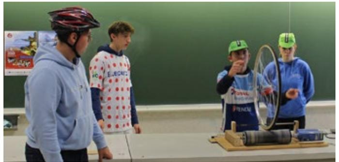
Quant aux élèves du lycée de Mulhouse, leur analyse approfondie de l'équilibre d'un vélo en mouvement a révélé des détails surprenants. En mettant en lumière des paramètres tels que la chasse, l'effet gyroscopique et la répartition des masses, ils ont démontré la subtilité de l'équilibre, souvent contre-intuitif mais pourtant naturel dans notre quotidien.
